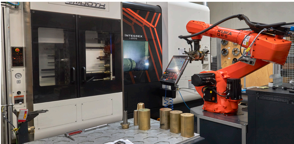
Den ene CNC-maskine står her og fræser, mens robotarmen er klar til at skifte emner og værktøj. De rå bronzeemner står klar på bordet i en bestemt orden i en matrix.
