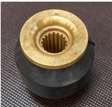
Den vulkaniserede gummikobling er karakteristisk for Flexofolds nav til sejldrev. Den forbinder den indre del omkring drevets spline med den ydre del, der huser propelbladene, og er med til at isolere propellen fra drevet.
