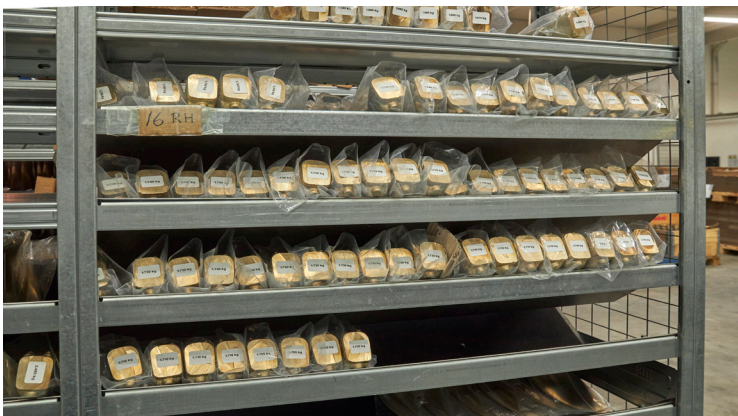
Her ligger de støbte propelblade klar til at blive sat i produktion.
