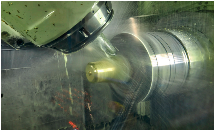
Her er det massive nav til aksel, der er ved at blive fræset i en CNC-maskine.
