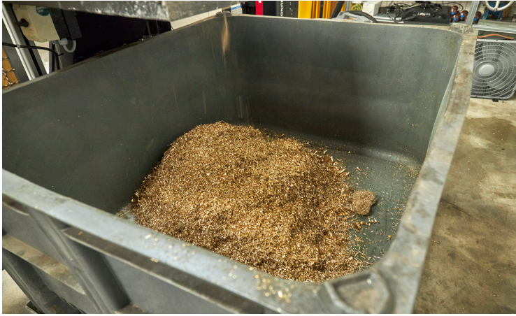
CNC-maskiner fræser i kassevis af spåner af emnerne. Spånerne bliver genbrugt til at støbe nye nav-æmner eller propelblade. Bemærk spåner, der falder ned i kassen øverst i midten af billedet.
