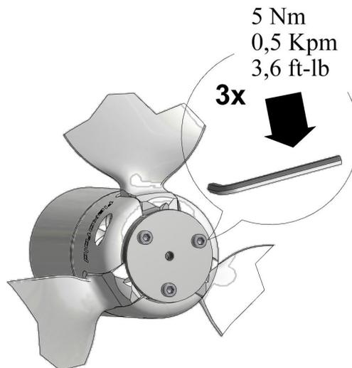
**8** Die Opferanode, Zn oder AlMg (11) mit Schrauben (12). Mit Hilfe des mitgelieferten Sechskantschlüssel (15) festschrauben. Etwa 10 Nm Anziehmoment. Prüfen Sie ob die Flügel sich frei bewegen. Nichts darf die Bewegung hindern.
