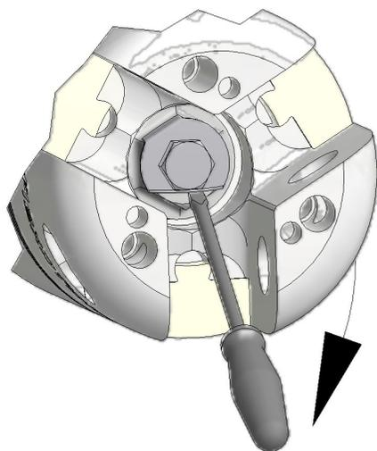
Bei der Demontage wird die hochgebogene Kante der Sicherungsblech zurückgedrückt. Erst dann ist die Sicherungsschraube (6) lösbar.
