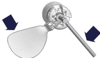
**3** Sicherungsschraube (6), vom Werk her mit Schraubensicherung versehen, sonst neu bestreichen, mit aufgesetztem Sicherungsblech (5) durch das Loch in der Wellenmutter (4) in die Saildrivewelle einschrauben. Festziehen mit etwa 15 Nm. Mit eine Schraubendreher wird die Nase vom Sicherungsblech (5) über eine Schlüsselfläche der Wellenmutter (4) gebogen.
