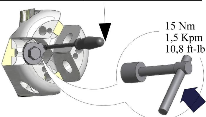
**4** Mit dem Schraubendreher wird nun eine Kante des Sicherungsblechs gegen eine Schlüsselfläche der Sicherungsschraube hochgebogen. Diese Kombination von Schraubensicherung und doppelt gebogenem Sicherungsblech, verhindert, dass die Nabe sich von der Welle lösen kann.
