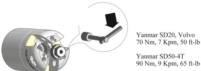
**2** Die Mutter (4) anschrauben und mit etwa 70 Nm anziehen. Gegenhalten mit einem Flügel (Handschuh!).
