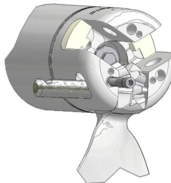
**6** Den zweiten und dritten Flügel (6) einsetzen und mit Bolzen (7) montieren. Wieder erleichtern leichte Bewegungen mit dem Flügel diese Operation. Keine Gewalt anwenden. Keilbolzen (8) einsetzen. Prüfen Sie ob die Flügel sich frei bewegen. Nichts darf die Bewegung hindern.
