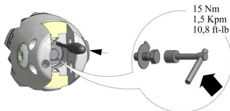
**3** Mit dem Schraubendreher wird nun eine Kante des Sicherungsblechs gegen eine Schlüssel­fläche der Sicherungsschraube hochgebogen. Diese Kombination von Schraubensicherung und doppelt gebogenem Sicherungsblech verhindert, dass die Nabe sich von der Welle lösen kann.
