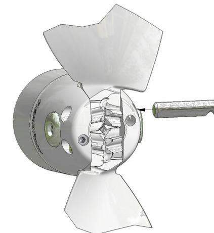
**8** Die beiden Sicherungsschrauben (9) mit dem mitgelieferten Sechskantschlüssel festziehen.
