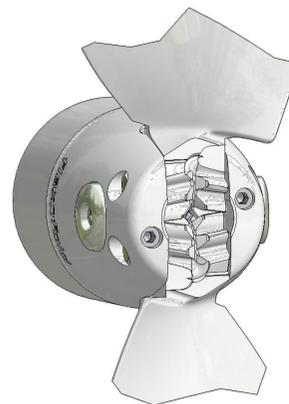
**6** Den zweiten Flügel (7) einsetzen und mit einem Bolzen (8) montieren. Wieder erleichtern leichte Bewegungen mit dem Flügel die Operation. Keine Gewalt anwenden.
