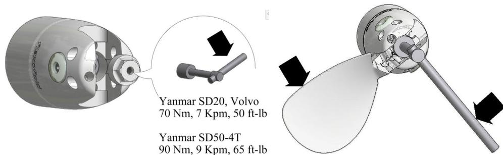
**2** Sicherungsschraube (6), vom Werk her mit Schraubensicherung versehen, sonst neu bestrichen, mit aufgesetztem Sicherungsblech (5) durch das Loch in der Wellenmutter (4) in die Saildrivewelle einschrauben. Festziehen mit etwa 15 Nm. Mit einem Schraubendreher wird die Nase vom Sicherungsblech (5) über eine Schlüssel­fläche der Wellenmutter (4) gebogen.
