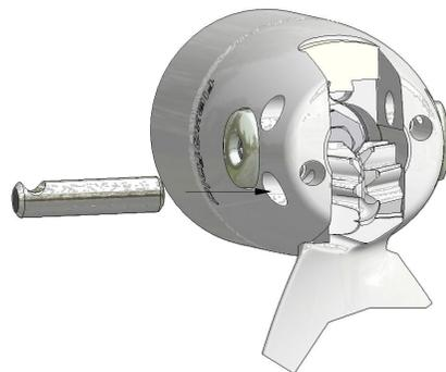
**5** Sicherungsschraube (9) einsetzen bis etwa 2 Gewindegänge greifen. Wieder erleichtern leichte Bewegungen mit dem Flügel die Operation.
