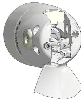
**7** Die zweite Sicherungsschraube (9) einsetzen bis etwa 2 Gewindegänge greifen. Wieder erleichtern leichte Bewegungen mit dem Flügel die Operation. Die Sicherungsschraube wird erst in Stufe 8 ganz festgezogen.
